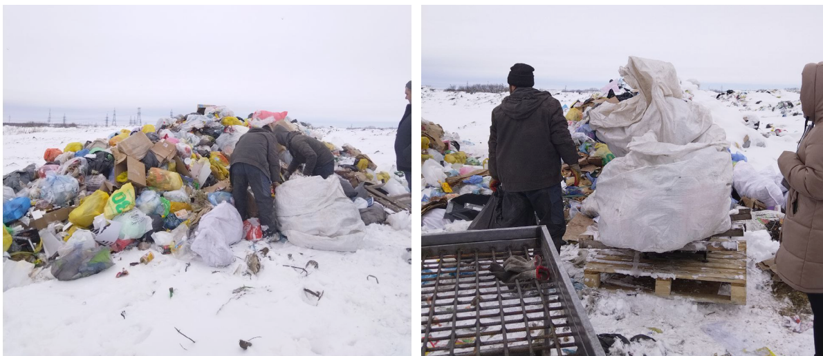
Рис. 3. Отбор и взвешивание пробы ТКО: слева – отбор; справа – взвешивание (фото А.В. Антипиной)
