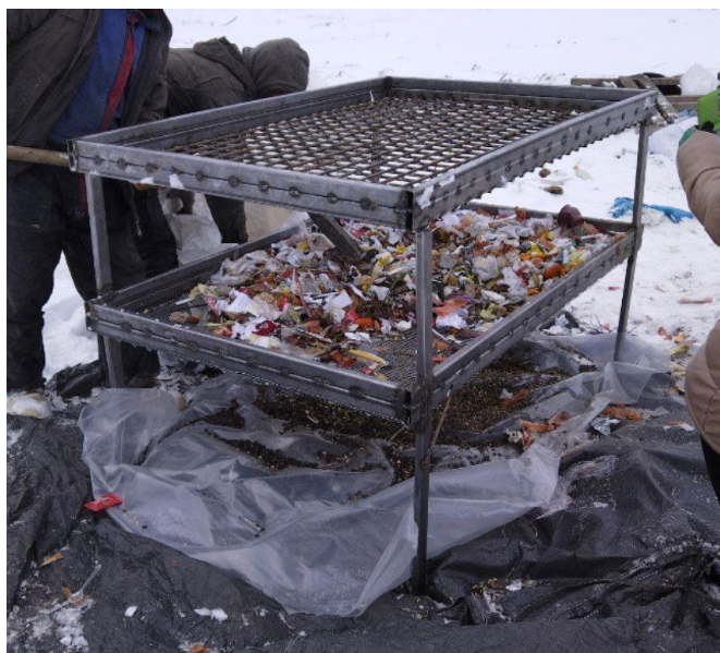
Рис. 5. Определение морфологического состава фракции 10-50 мм (фото А.В. Антипиной) Fig. 5. Determining the morphological composition of the 10-50 mm fraction (photo by Antipina A.V.)
