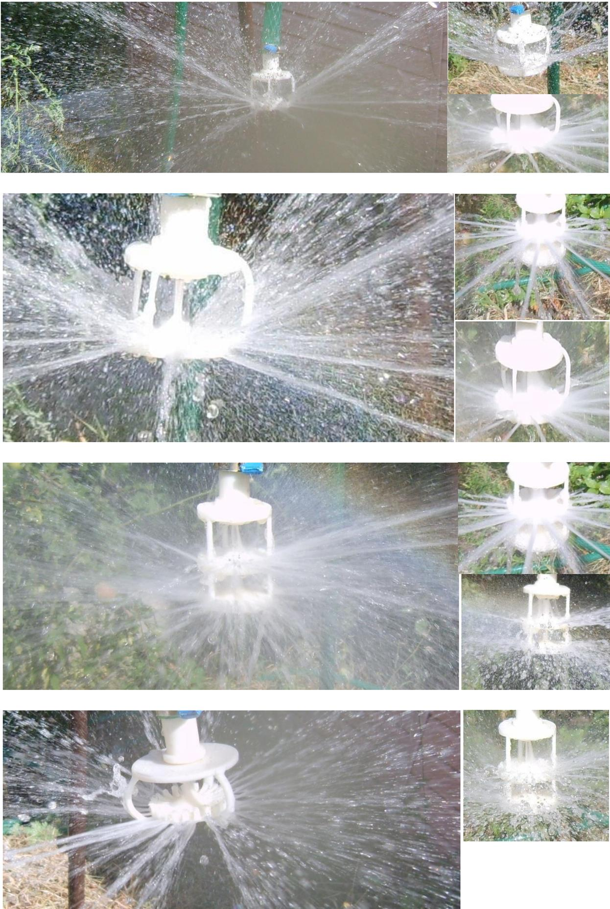
Рисунок 8.2 - Сходящийся поток для разных форм дефлектора
