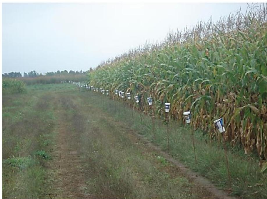
Рисунок 8.4 – Расстановка дождемеров
