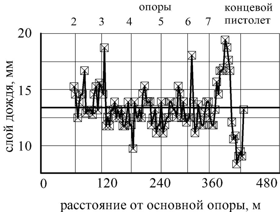
Рисунок 8.10- Распределение воды в опыте 6 (13,4 мм при 100% равномерности распределения)
