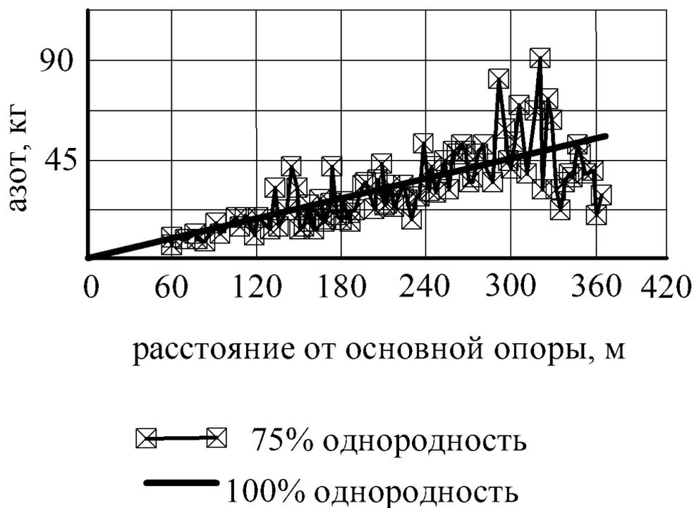
Рисунок 8.18- График внесения 90 кг азота в течение сезона с помощью фертигации в тесте 4 (фактическое применение азота по сравнению со 100%-ной однородностью)
