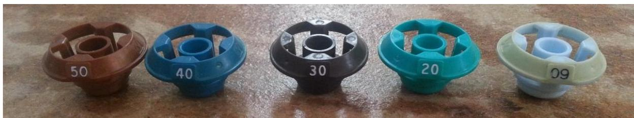
Рисунок 10.6- Сопла, использованные при испытании (статический дефлектор)
