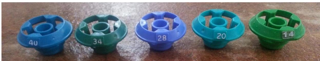
Рисунок 10.5- Сопла, используемые для испытаний (вращающейся дефлектор)
