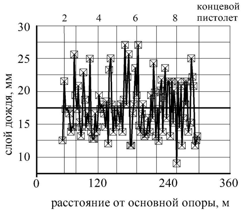
Рисунок 8.11- Распределение воды в опыте 7 (17,7 мм при 100% равномерности распределения)
