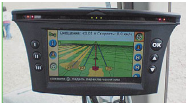
Рис. 5.14. Интерфейс навигационного прибора EZ-Guide 500 Lightbar для системы «Автопилот» в работе
