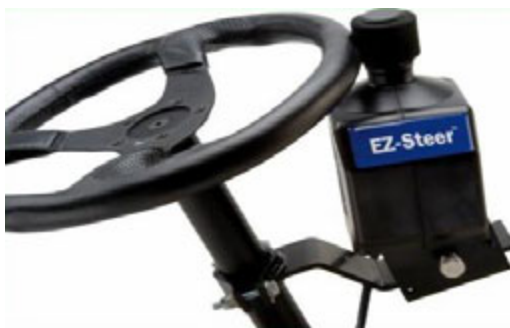
Рис. 7. Подруливающее устройство Trimble EZ-Steer
