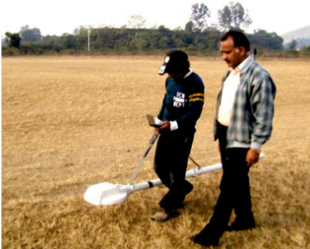
Рис. 6.19. Электромагнитный сканер «Немфис» (ИНГГ СО РАН)
