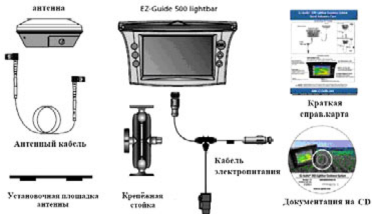
Рис. 5.2. Стандартные компоненты для параллельного вождения
