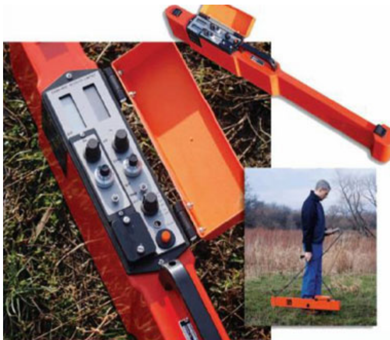
Рис. 6.18. Сканер электропроводности почвы (рисунок с сайта http://www.eco-razum.com )
