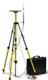
Рис. 5.11. Контрольно-корректирующая станция (станция RTK)
