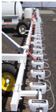
Рис. 7.1. Принципиальная схема работы прибора GreenSeeker (WeedSeeker) в комплекте с бортовым компьютером и опрыскивателем при внесении по технологии online . Справа – опрыскиватель с 40 головками WeedSeeker, подключены к собственной форсунке
