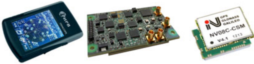
Рис. 2.3. Типы навигационных приемников (устройство, плата, модуль)
