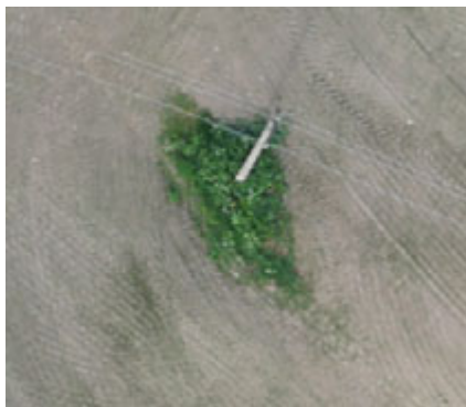
Рис.3.1. Изображение опоры ЛЭП, пиксельное разрешение 5 см
