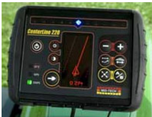
Рис. 12. Система параллельного вождения (курсоуказатель) CenterLine 220
