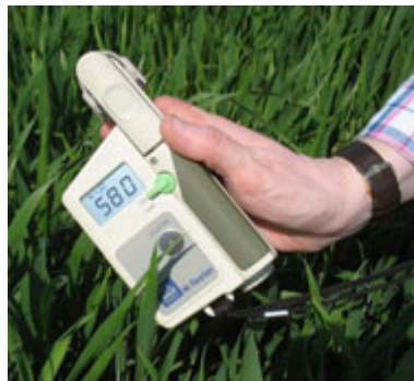
Рис. 7.6. Оптический датчик Yara N-Tester™. Измерение по листу
