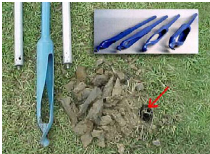
Рис. 6.5. Ручной почвенный пробоотборник с различными наконечниками
