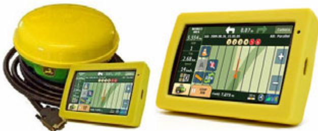
Рис. 28. Система параллельного вождения, курсоуказатель G 6 Farmnavigator
