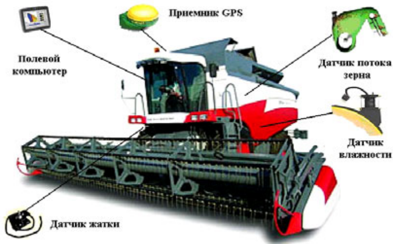
Рис. 6.24. Расположение оборудования на зерноуборочном комбайне для картирования урожайности
