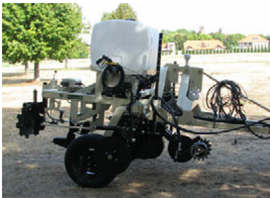
Рис. 6.10. Мобильный анализатор свойств почвы от компании «Veris Technologies» с системой навигации Garmin
