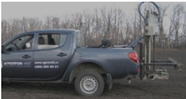
Рис. 6.8. Передвижная почвенная лаборатория точного земледелия (рисунок с сайта http://www.agromdt.ru )
