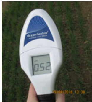
Рис. 7.5. Оптический датчик GreenSeeker Handheld, ручные измерения NDVI посева
