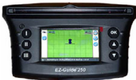
Рис. 4. Устройство параллельного вождения Trimble EZ-Guide 250
