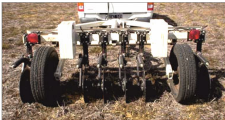
Рис. 6.17. Картирование электропроводности почвы с помощью прицепного агрегата Veris 3100 (компания «Veris Technologies», США)
