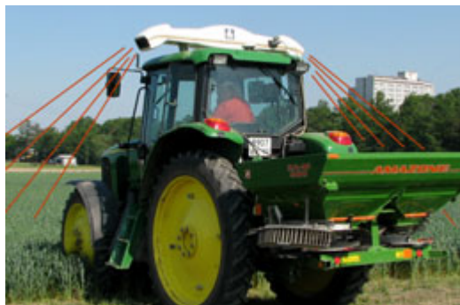
Рис. 7.3. Принципиальная схема обследования посевов оптическим датчиком N-Sensor Yara в комплекте с распределителем гранулированных удобрений Amazone для внесения по технологии online
