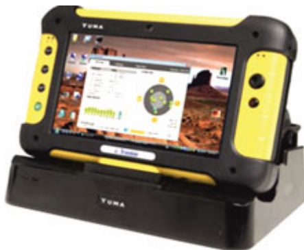
Рис. 34. Планшетный компьютер Yuma (компания «Trimble»)
