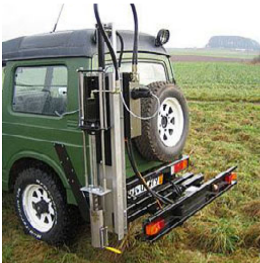
Рис. 6.9. Автоматический пробоотборник почвы N 2000 («Bodenprobetechnik Nietfeld»)
