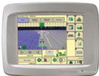
Рис. 20. Система параллельного вождения Green Star John Deere
