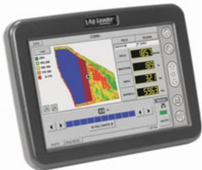
Рис. 5.7. Полевой компьютер Insight с программным обеспечением
