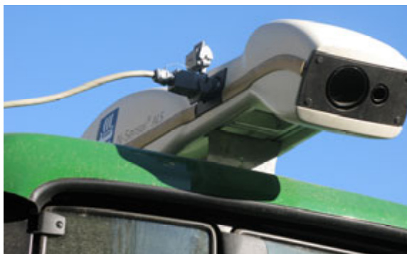
Рис. 8.4 Сканирующая система Yara N-Sensor® ALS, установленная на крыше кабины трактора
