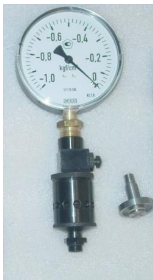
Рис. 2.1. Общий вид приборов АГЦ-3 и АГЦ-3/3 а — АГЦ-3; б — АГЦ-3/3
