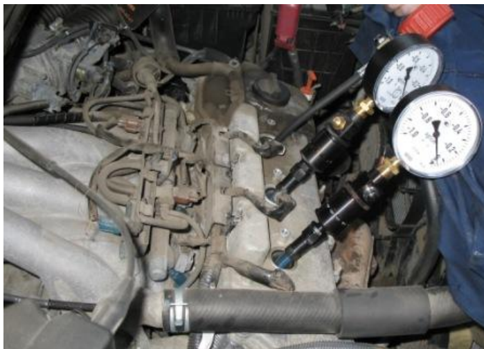
Рис. 2.14. Подключение АГЦ-3 к свечным отверстиям с помощью гибкого штока
