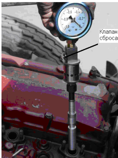
Рис. 2.10. Установка АГЦ-3 с переходным устройством в форсуночное отверстие
