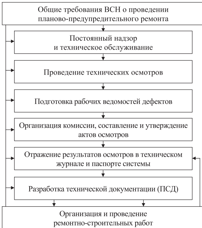
Рисунок 4.2 – Порядок подготовки планово-предупредительных ремонтов
