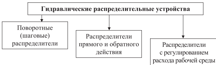
Рисунок 5.2. – Классификация гидравлических распределительных устройств
