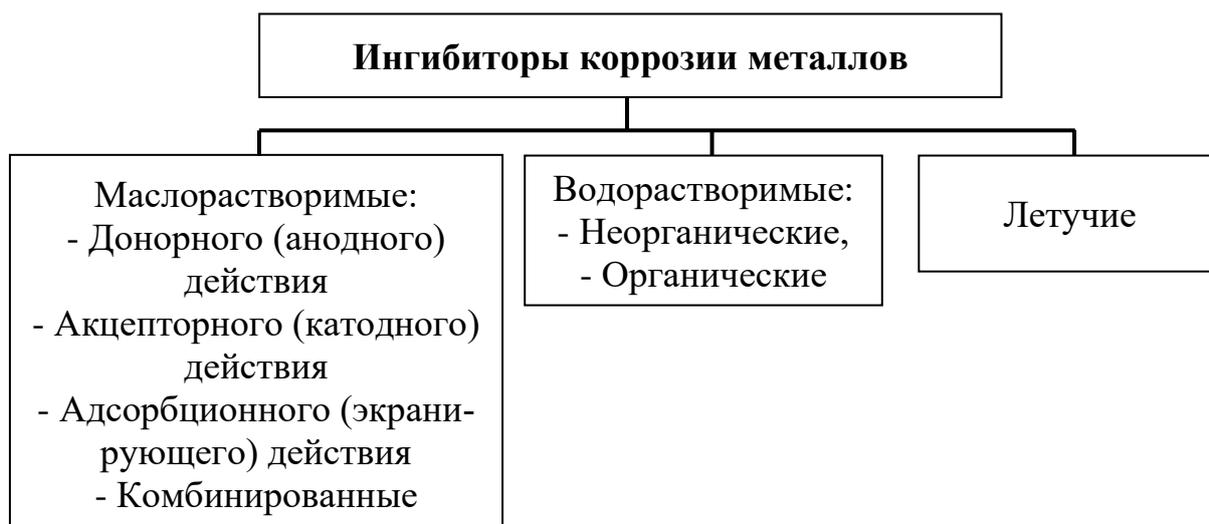
**Рисунок 2 – Классификация ингибиторов коррозии**
