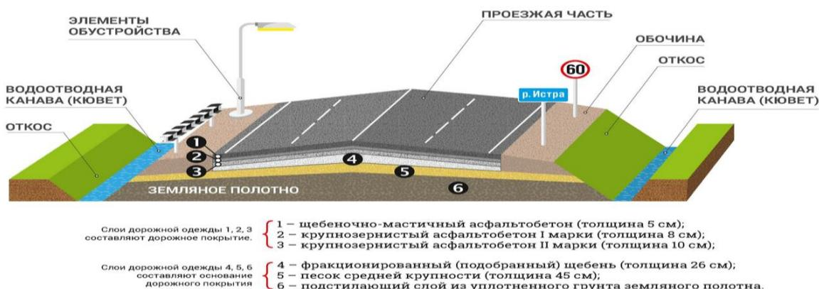
**Рисунок 1 – Слои дорожной конструкции для автодороги 1 категории под осевую нагрузку 11,5 т.**
