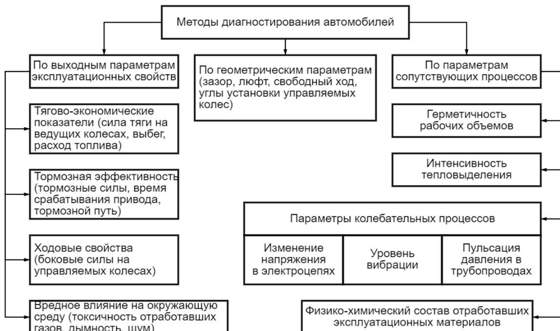
**Рисунок 3 – Методы диагностирования автомобилей**
