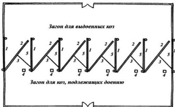
Рис. 15. Схема устройства струнга: 1 — неподвижные щиты, 2 — подвижные щиты, 3 — железные крюки, 4 — места для доярок, 5 — места для коз во время доения
