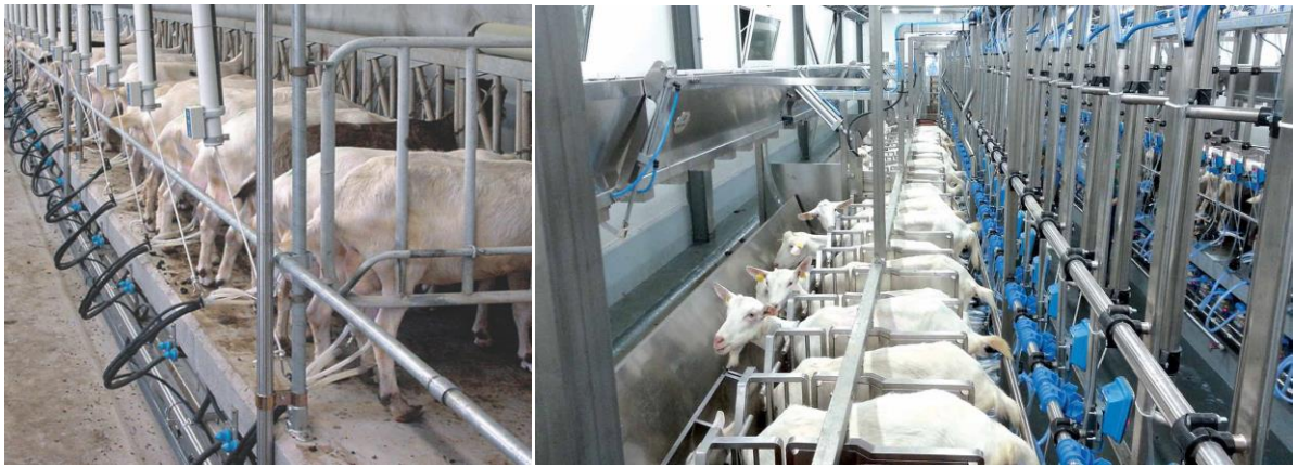
Рисунок 60 – Доильная установка типа «Параллель» с доильной ямой: А) – с боковым выходом, Б) – с быстрым выходом.
