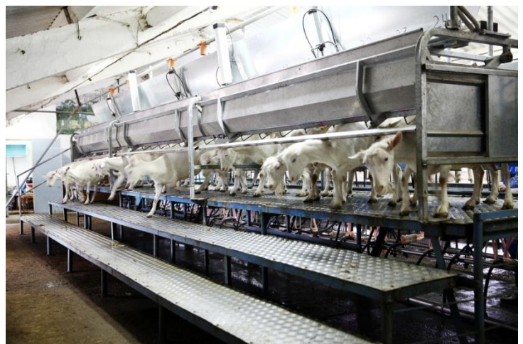
Рисунок 61 – Доильная установка типа «Параллель» на эстакаде: А) – с боковым выходом, Б) – с быстрым выходом.
