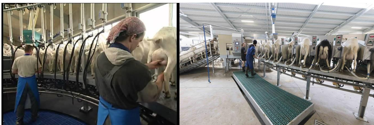
Рисунок 62 – Доильная установка типа «Карусель»: А) – с внутренним доением, Б) – с внешним доением.
