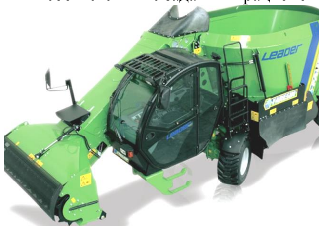
Рисунок 29 – Самоходный кормомиксер с фрезерным погрузчиком.
