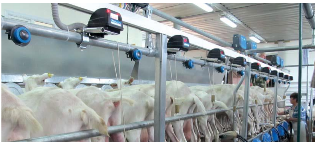
Рисунок 64 – Доильная установка с контроллерами доильного поста.
