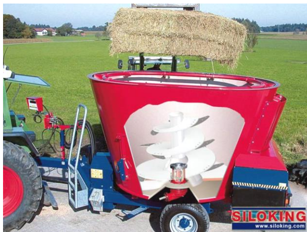
Рисунок 32 – Прицепной кормомиксер с вертикальным шнеком.
