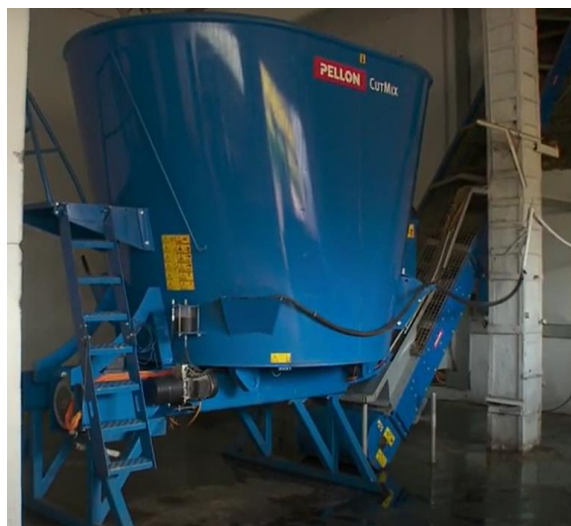
Рисунок 27 – Загрузка корма в кормовой миксер, и подача на кормовую ленту.
