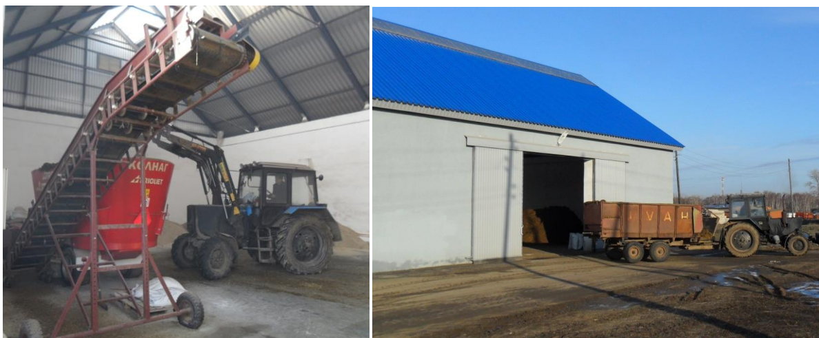
Рисунок 34 – Стационарный вертикальный кормомиксер с загрузочным транспортером в прицепной кормораздатчик для раздачи корма в старых зданиях с низким проемом ворот.
