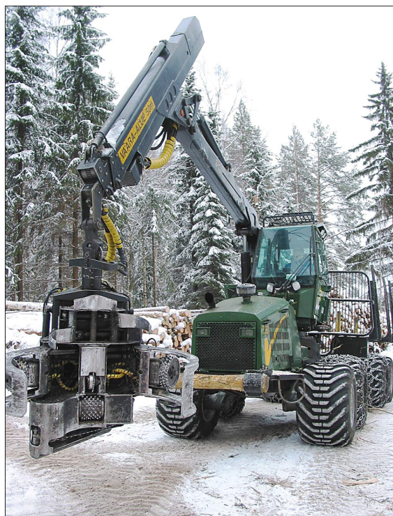
Рисунок 2.15. Харвардер РІКА 728. (Фотография: Юха Лайтила)
