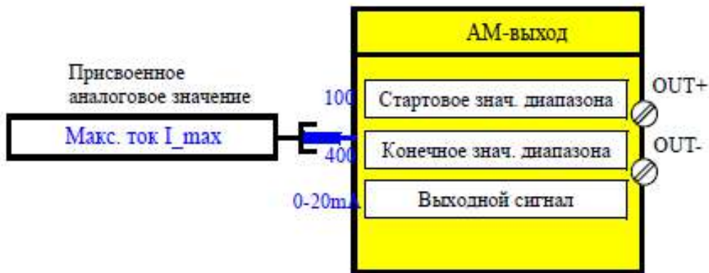
Рис. 4.10. Пример настройки функционального блока «АМ-выход» в диапазоне токов перегрузки электродвигателя
