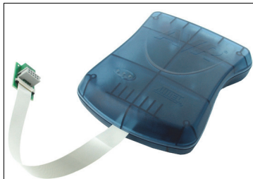
Рис. 16.6. Программатор-отладчик JTAGICE mkII для микроконтроллеров с ядром AVR
