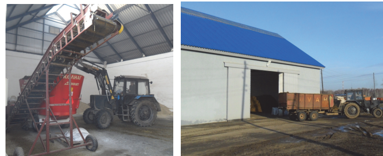
Рис. 5.6. Приготовление кормосмеси в стационарном кормосмесителе с последующей перегрузкой в прицепной тракторный кормораздатчик для ее транспортировки и раздачи в старых коровниках с низким проемом ворот
