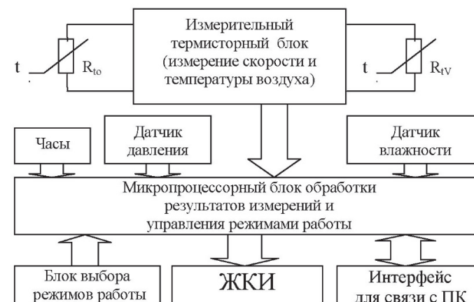
Рис. 11.1. Блок-схема Измерителя «Метеоскоп-М»
