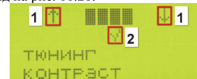
Рис. 11.20. Установка контрастности ЖКИ
