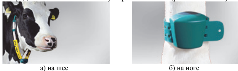
Рис. 6.7. Расположение датчиков идентификации на животном
