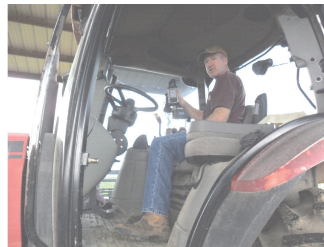
Рис. 5.4. Бортовой компьютер кормосмесителя, управляемый по радиоканалу
