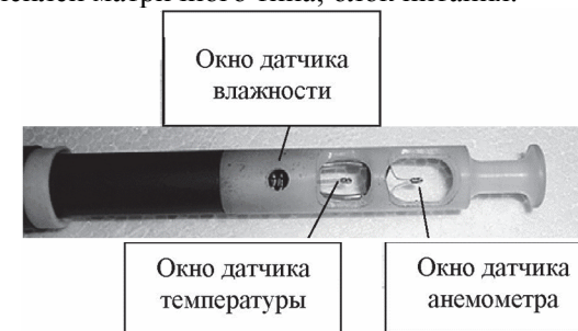
Рис. 11.2. Головка сенсометрического щупа
