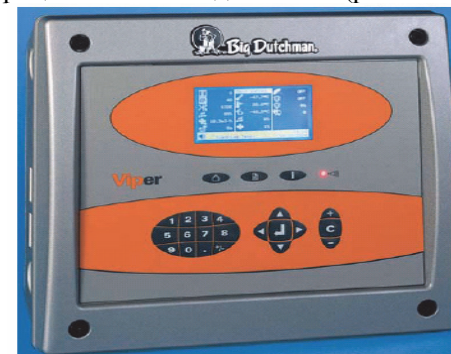
Рис. 10.12. Компьютер для управления микроклиматом и технологическими процессами (модель – ВАЙПЕР)
