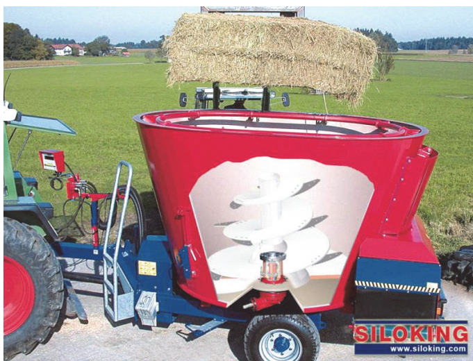
Рис. 5.3. Кормосмеситель с вертикальным шнеком
