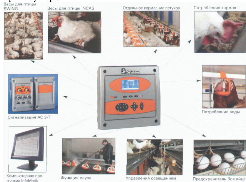
Рис. 10.14. Функциональные возможности компьютера ВАЙПЕР по управлению технологическими процессами
