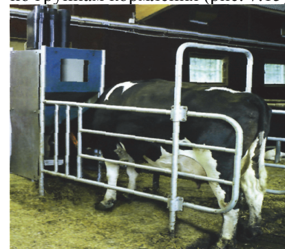
Рис. 7.14. Автоматическая станция индивидуального кормления сухими концентратами
