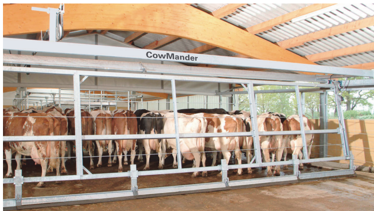
Рис. 6.17. Автоподгонщик с навозоборочным скребком
