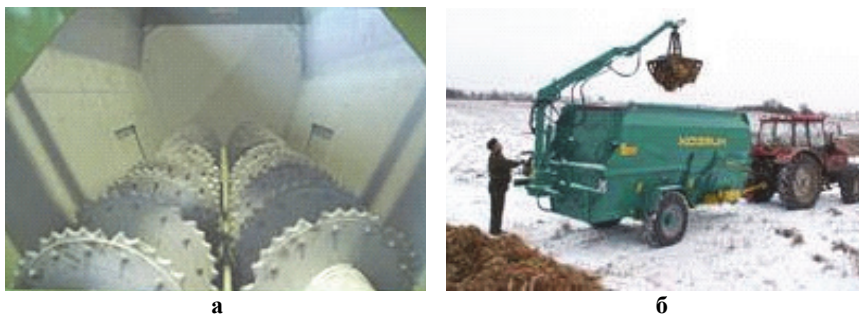
Рис. 5.2. Кормосмеситель с горизонтальными шнеками
