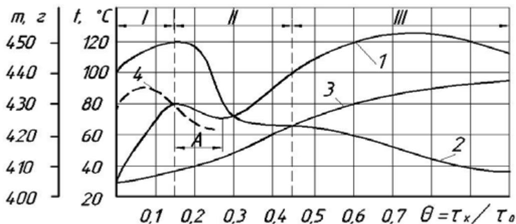
$m$  – масса;  $t$  – температура;  $\theta$  – относительное время выпечки. 1 – температура поверхности заготовки; 2 – масса заготовки; 3 – температура в центре мякиша; 4 – температура точки росы
