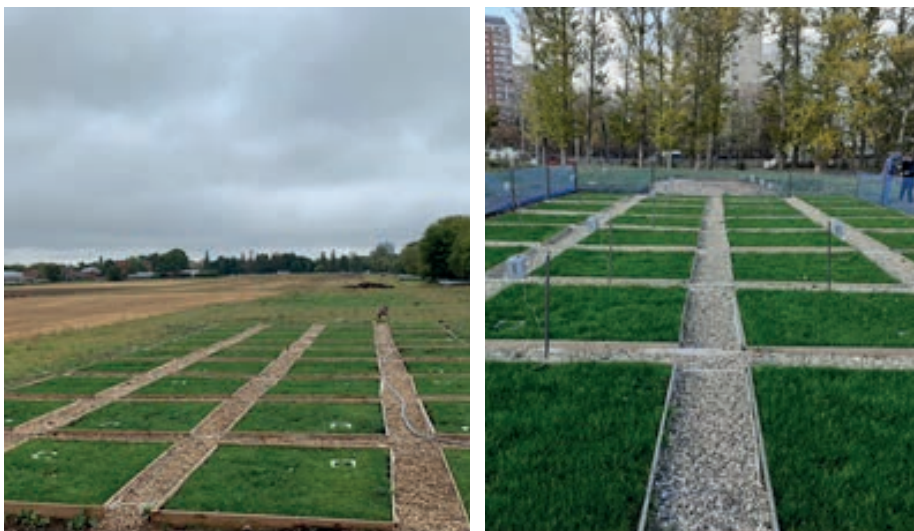
Рис. 2.4. Микрополевым эксперимент с основаниями напочвенных экспозиционных камер для проведения сезонного мониторинга почвенных потоков CO 2
