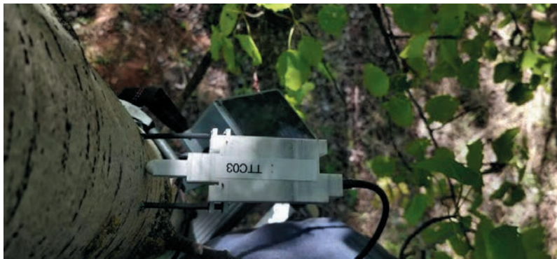
Рис. 31. Установка прототипа TT Carbon на ствол дерева
