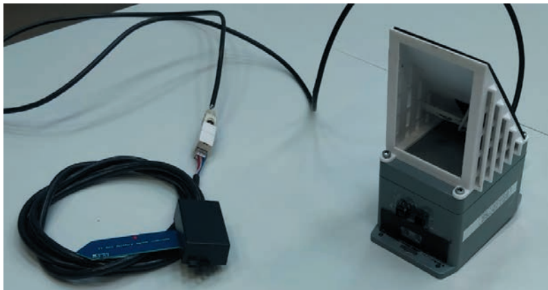
Рис. 4. Внешний вид устройства StopTalker с подключенным почвенным датчиком.
