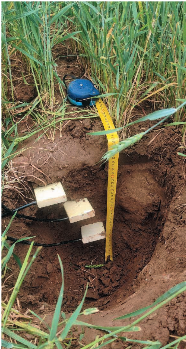
Рис. 33. Пример послойной установки почвенных датчиков ТТ SWAP в прикопке с вскрытием пахотного горизонта дерново-подзолистой почвы
