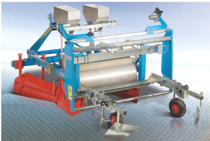
Рис. 24. Плёноукладчик-грядообразователь, модель AP
