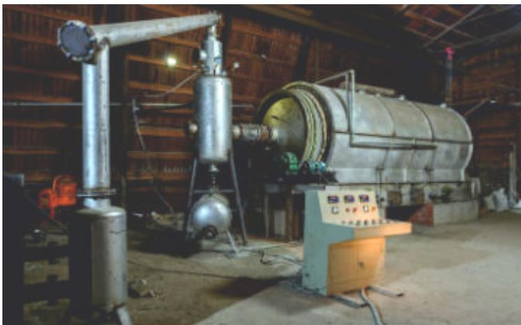
Рис. 32. Автоклав для утилизации полиэтилена
