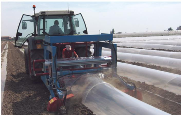
Рис. 28. Машина для формирования парников на дугах S200 в работе
