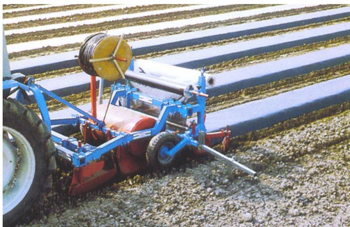
Рис. 25. Плёноукладчик-грядообразователь в работе
