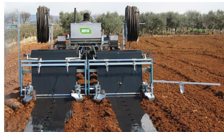
Рис. 23. Плёнкоукладчик-грядообразователь, модель AP
