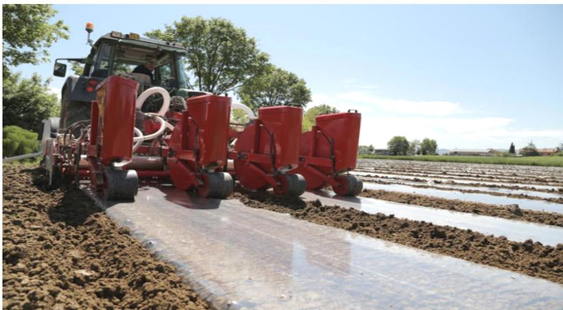
Рис. 29. Машина для посева с мульчированием пленкой Sparreri SMP
