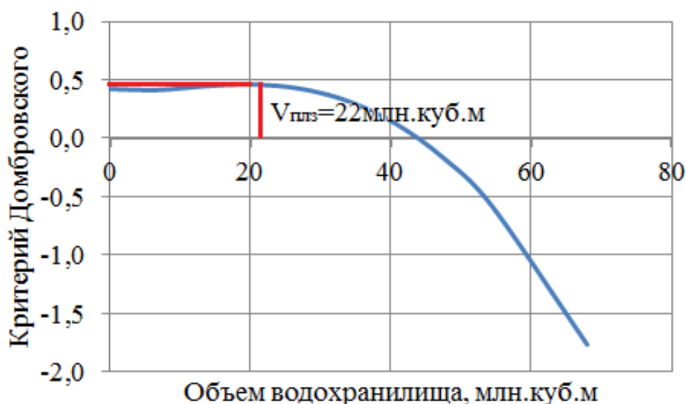
Рисунок VII.2 – Пример зависимости суммарного критерия оптимизации (f) от объема воды в водохранилище (V) для неравнозначных критериев
