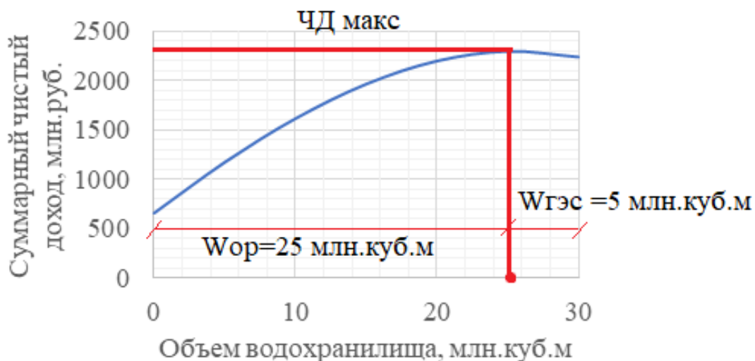
Рисунок IX.1. – Изменение чистого дохода в зависимости от объемов использования воды из водохранилища для целей орошения и гидроэнергетики
