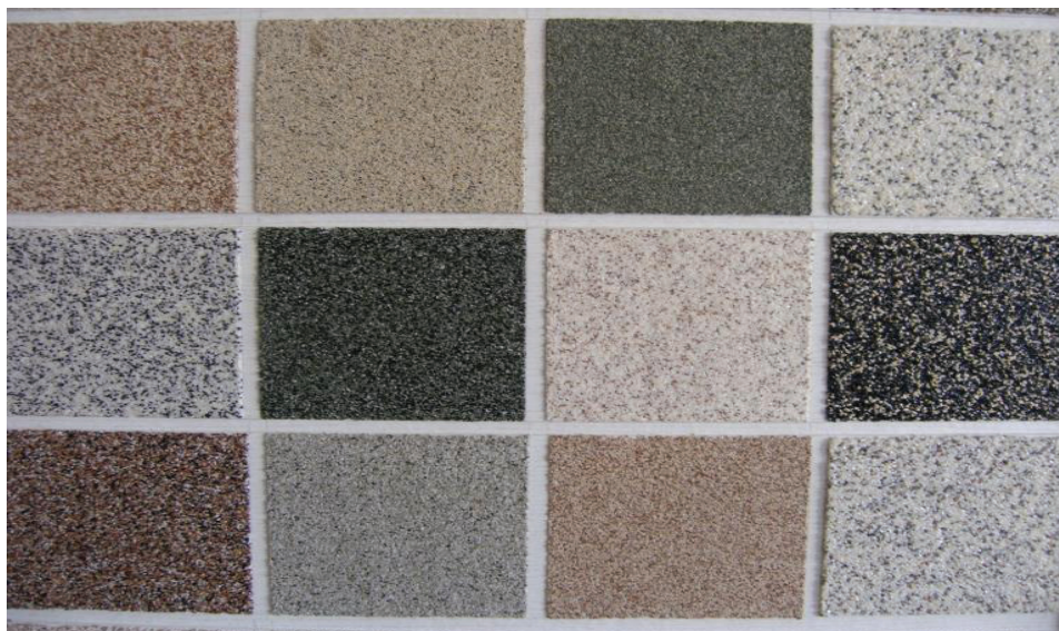
Рисунок 4.8 – Штукатурка на основе мраморной крошки
