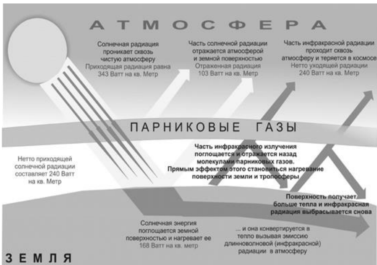
Рис. 19.1. Схема парникового эффекта
