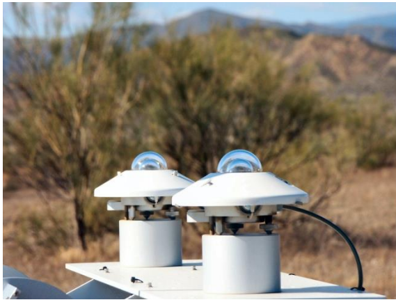
Установка из 2-х пиранометров CMP 11
