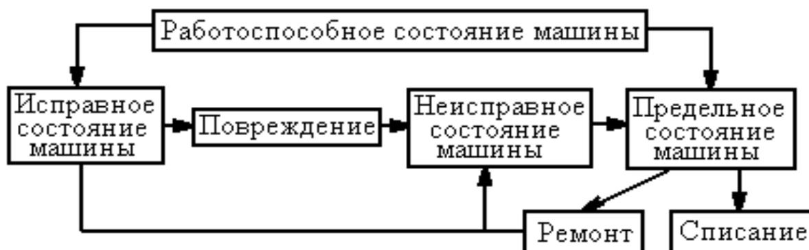
Рис. 2.1 Диаграмма технического состояния машины
