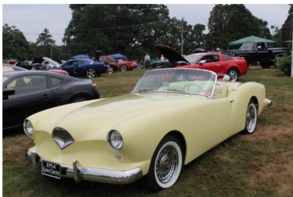
Рис. 3.10. Спорткар Kaiser-Darrin с корпусом из стеклопластика
