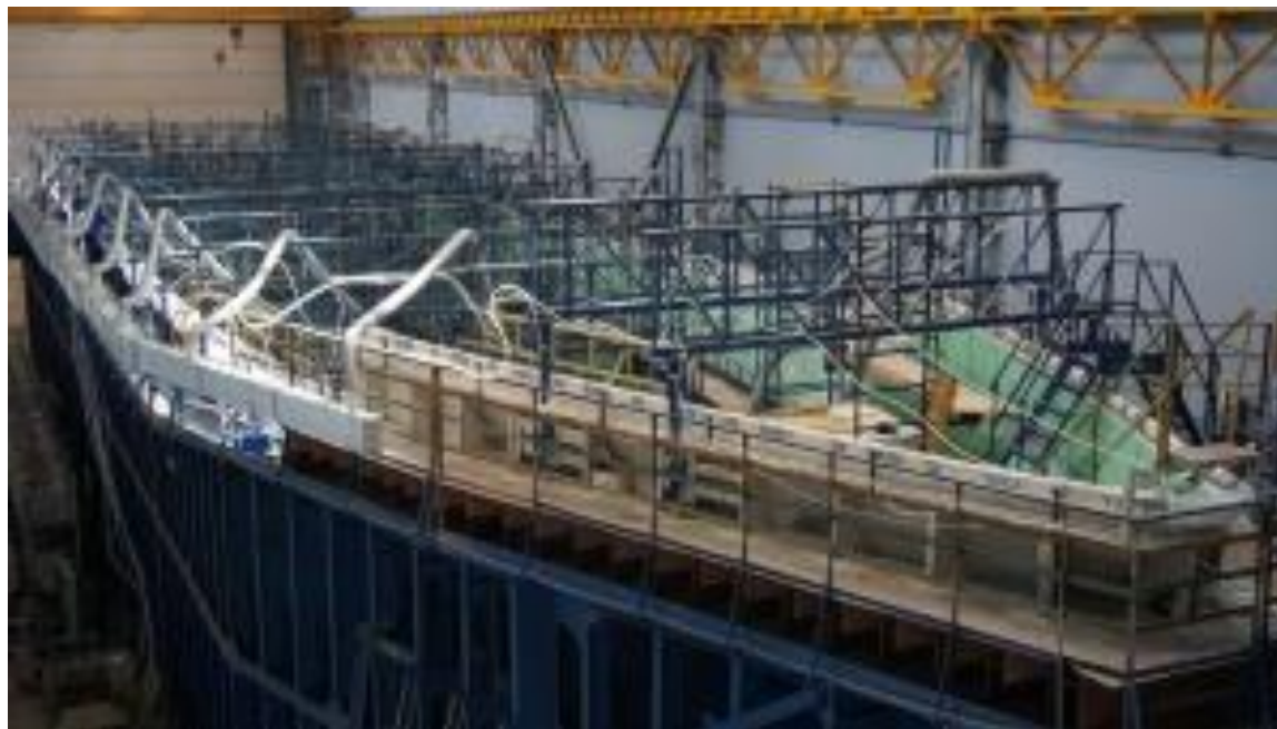
Рис. 3.8. Укладка ткани в матрицу при создании композитной оболочки 3 серийного тральщика проекта 12700 (шифр «Александрит»)
