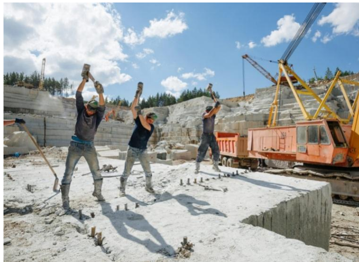
Рисунок 2.5 – Буроклиновой способ разработки твердых пород
