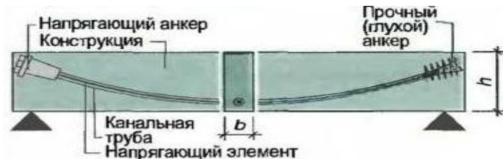
Рисунок 7.10 – Предварительное напряжение с последующей связью (на бетон)
