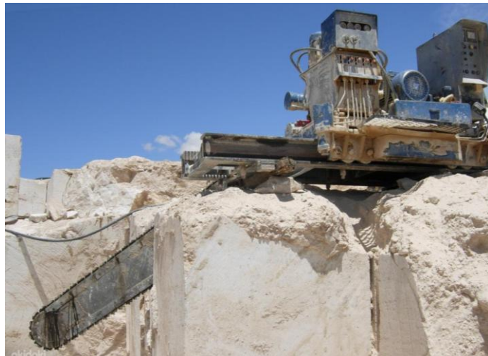
Рисунок 2.4 – Распиловка крупных блоков из пород средней твердости
