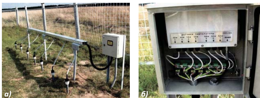
Рис. 4.15. Автоматический почвенный термометр АМТ-5: а) – общий вид; б) – датчики температуры
