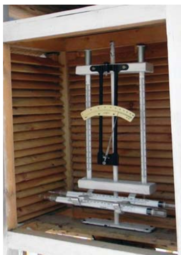
Рис. 5.2. Слева – общий вид установки психрометра Августа внутри психрометрической будки. Справа – психрометр Августа и его составные части:
