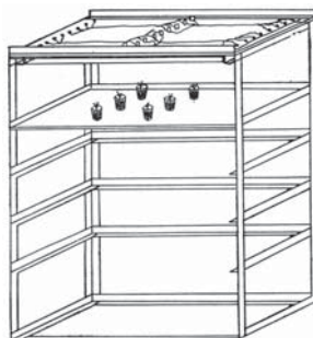
Рис. 12.9. Схематическое изображение вегетационного домика с подсветкой в верхней части
