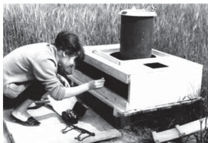
Рис. 8.9. Взвешивание испарителя с почвенным монолитом массой до 50 кг обеспечивает достаточную точность на весах, установленных в поле.
