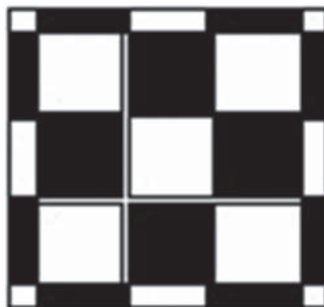
Рис. 3.6. Схема приёмника пиранометра М-80 М
