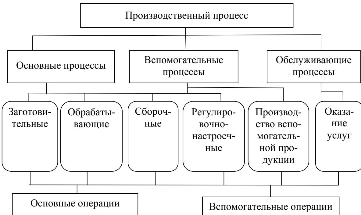
**Рис. 1. Структура производственного процесса**
