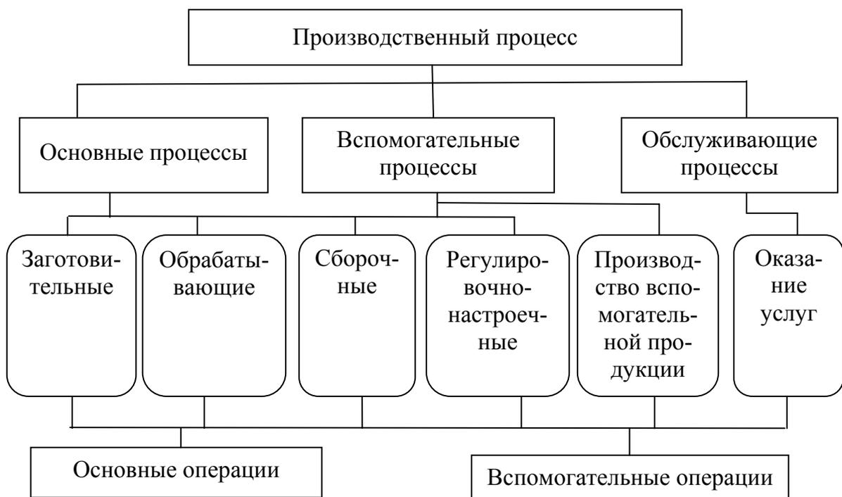
**Рис. 1. Структура производственного процесса**
