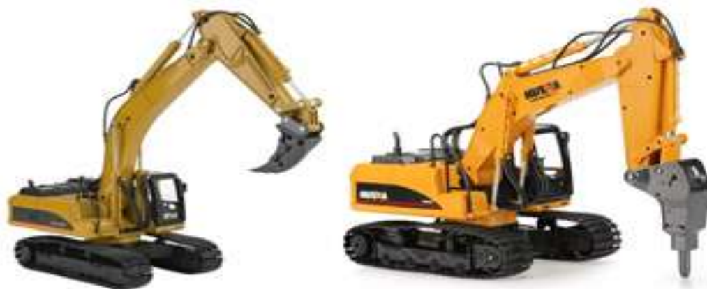
Рис. 141. Экскаватор с рабочим оборудованием: а) однозубый рыхлитель; б) гидромолот
