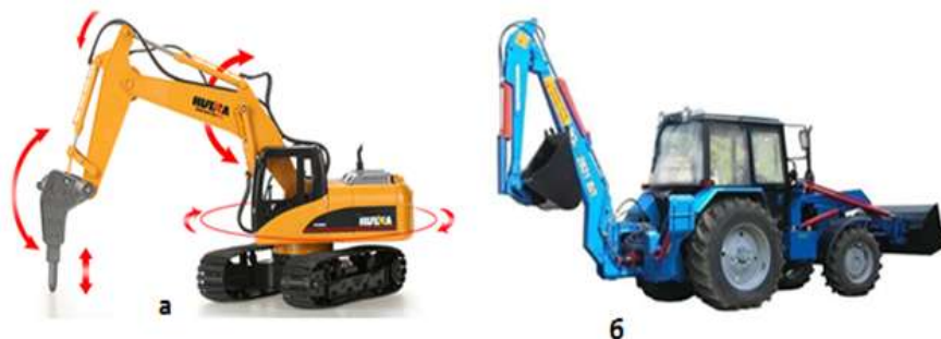
Рис. 133. Одноковшовые экскаваторы: а) полноповоротный; б) неполноповоротный
