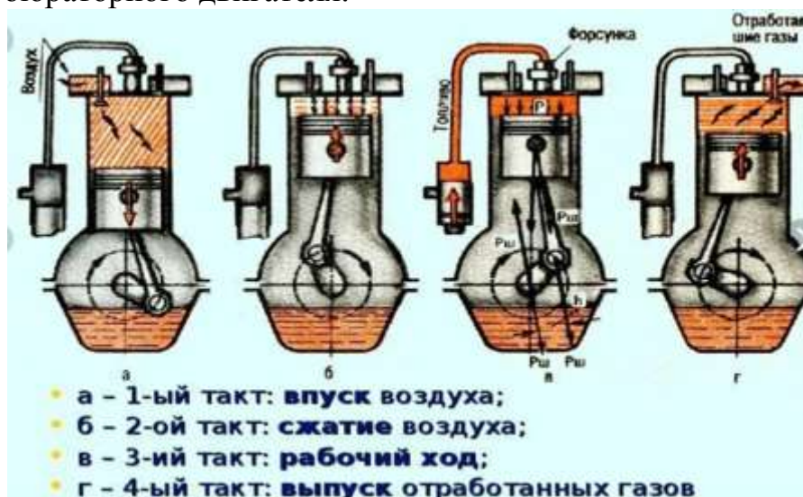
Рис. 59. Принцип работы дизельного двигателя
