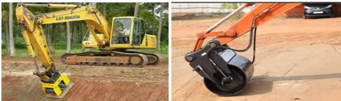
Рис. 288. Рабочие органы гидравлическим экскаватором для уплотнения дна и откосов канала: а) вибротрамбовщик. б) виброкаток
