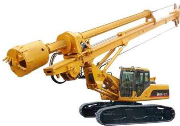
Рис. 178. Роторная буровая установка
