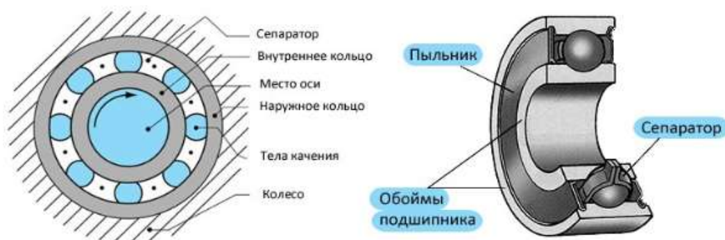
Рис. 24. Схема устройства подшипника качения
