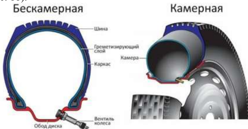
Рис. 88. Сечение бескамерной и камерной шин
