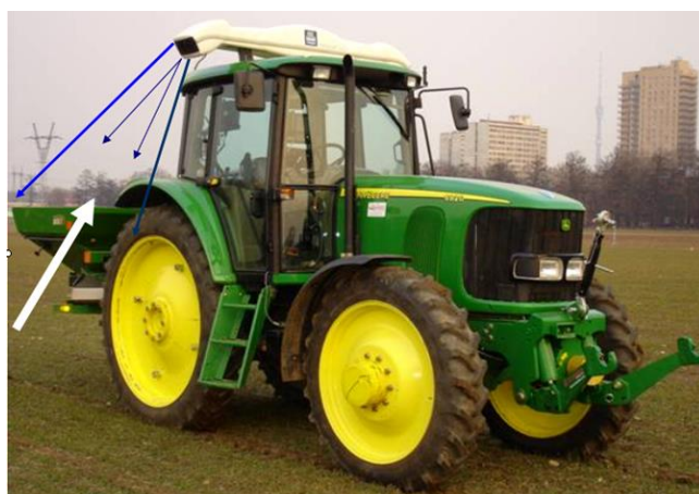
Рисунок 5.2.6 – Работа системы N-Sensor ALS с машиной для внесения удобрений
