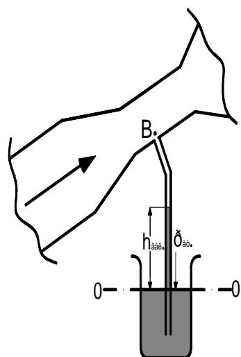
Рис.2.3 Схема вакуумметра
