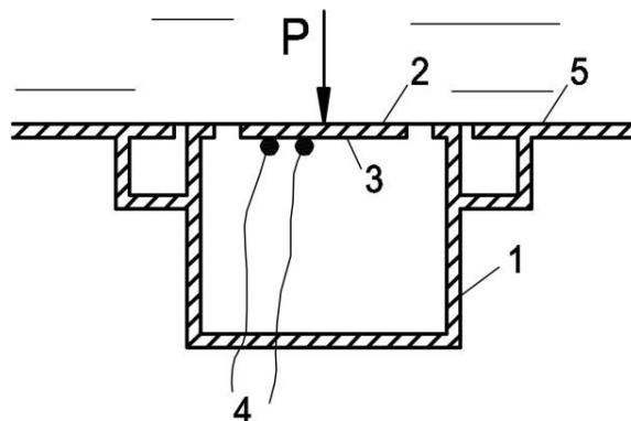
Рис. 2.12 Схема закрепления датчика для измерения давления
