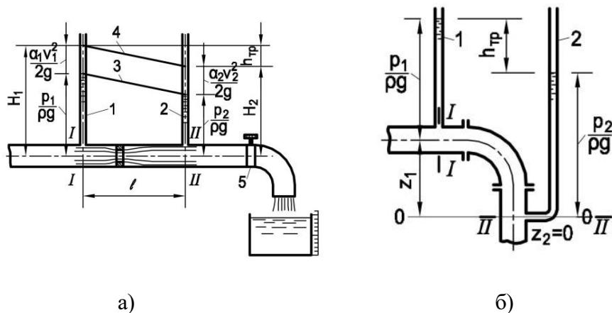
Рис.2.7 Схема лабораторной установки для определения местных потерь напора:
