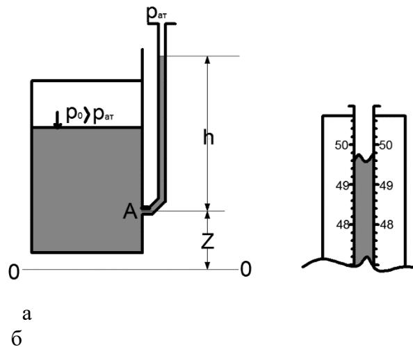
Рис.2.1 Схема жидкостного манометра
