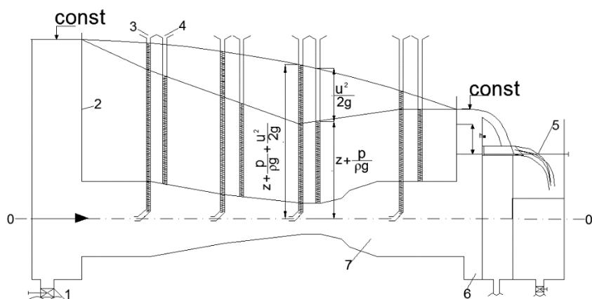
Рис.2.5 Схема лабораторной установки для изучения уравнения Бернулли:
