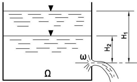
Рис.2.16 Схема лабораторной установки для изучения истечения жидкости через отверстия при переменном напоре
