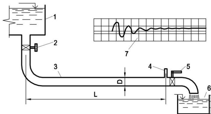
Рис. 2.18 Схема лабораторной установки для изучения гидравлического удара:
