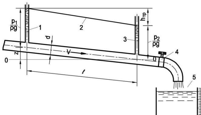
Рис.2.13 Схема лабораторной установки для определения потерь напора по длине:
