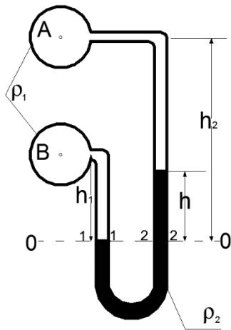
Рис.2.2 Схема дифференциального манометра
