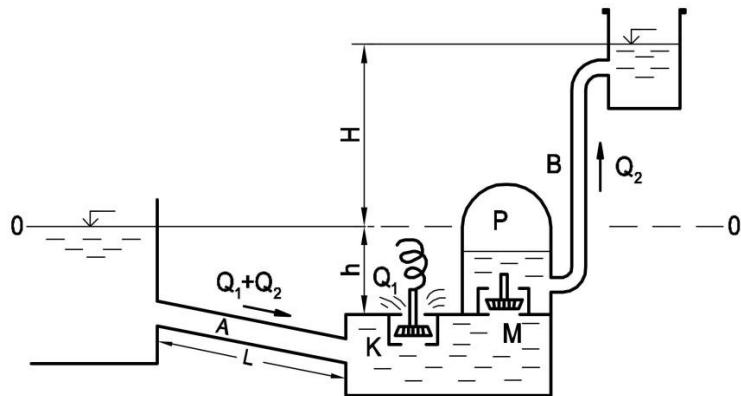
Рис. 2.19 Схема лабораторной установки для изучения гидравлического тарана
