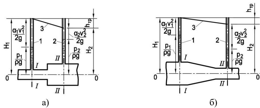
Рис.2.8 Схема внезапного расширения и плавного сужения:
