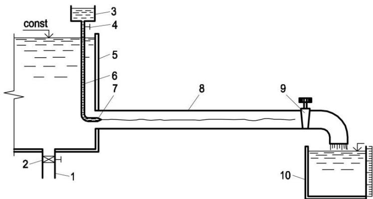
Рис.2.9 Схема лабораторной установки для изучения режимов движения жидкости:
