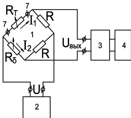
Рис. 2.11 Схема моста Уинстона
