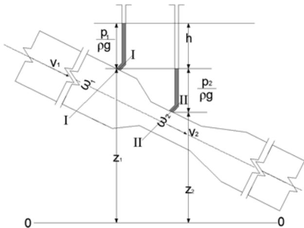
Рис. 2.6 Схема водомера Вентури
