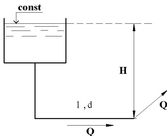
Рис.2.17 Схема простого трубопровода
