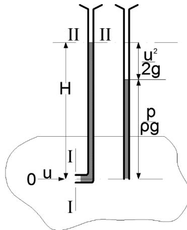
Рис.2.4 Схема действия скоростной трубы
