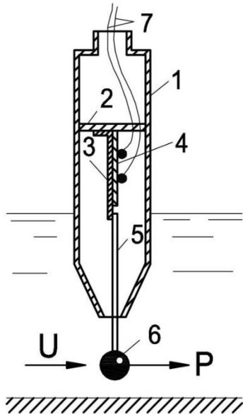
Рис.2.10. Схема тензодатчика для измерения скорости
