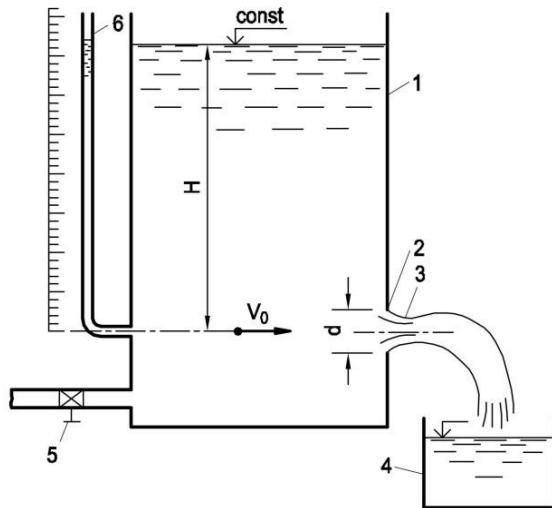
Рис.2.15 Схема лабораторной установки для изучения истечения жидкости через малые отверстия и насадки:
