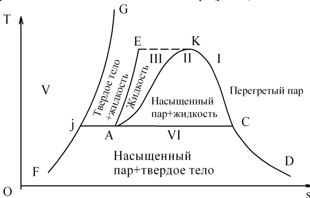
Рисунок 35 – Фазовая диаграмма для водяного пара в T, s координатах (температура-энтропия)
