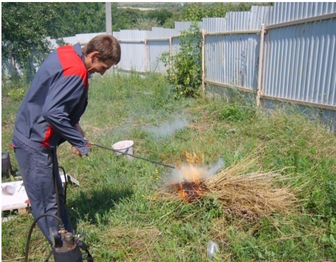
Рисунок 54- Подбор диаметров штанги и сопла парогенератора
