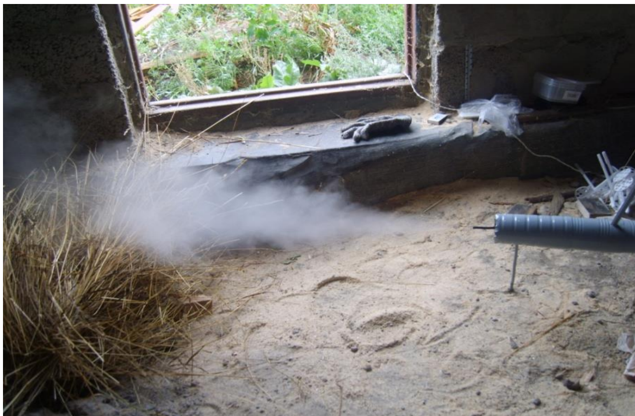
Рисунок 48 – Эффект смачивания сухой травы
