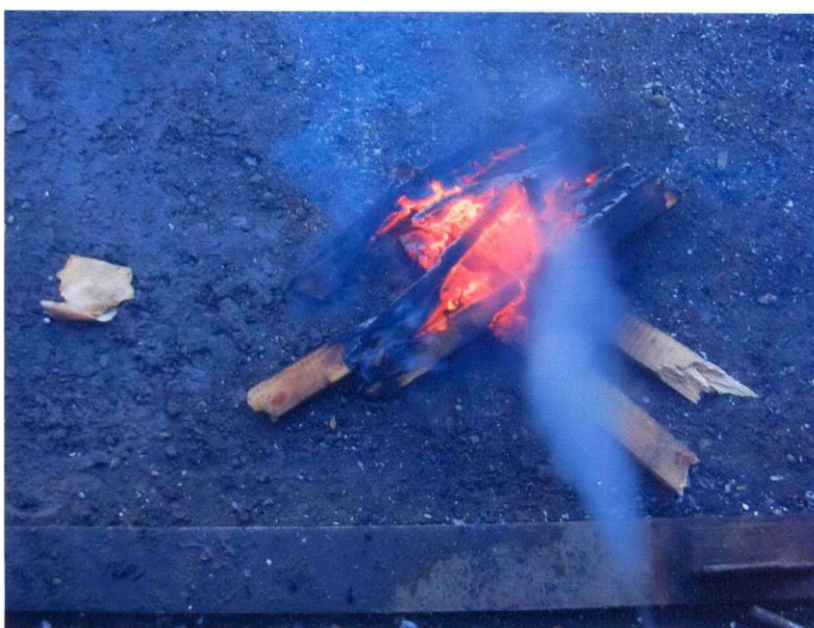
Рисунок 73 - Воздействие струи водяного пара на горящие бруски древесины
