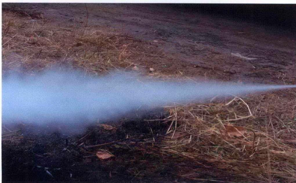
Рисунок 74- Воздействие струи водяного пара на фронт низового лесного пожара
