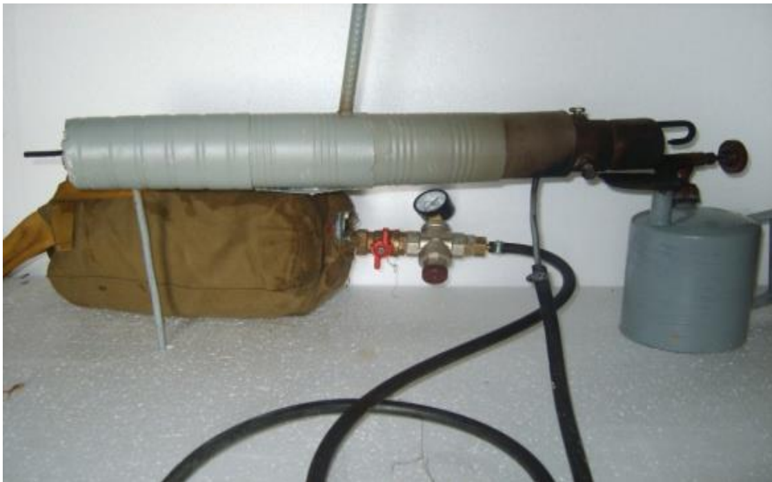
Рисунок 44 Автономная парогенераторная установка, подготовленная к работе (с защитным кожухом и рюкзаком)
