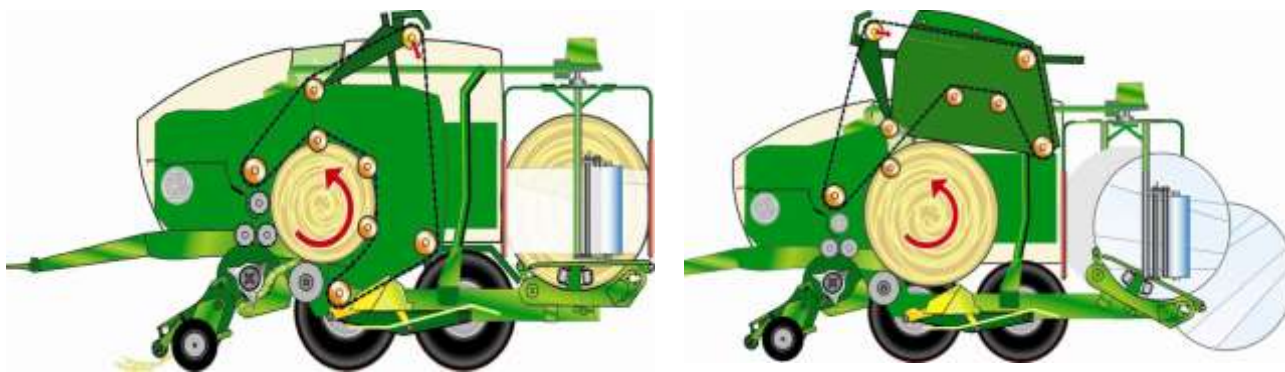
Рис. 14. Принцип работы комбинации с обмотчиком
