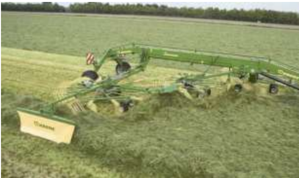
Рис. 12. Валкователи с укладкой валка на сторону
