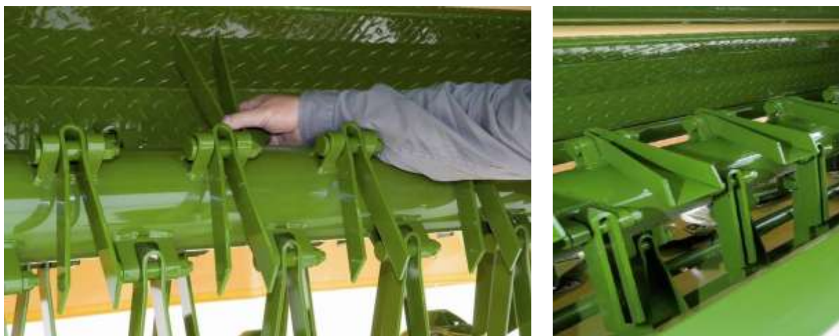
Рис. 6. Плющилка KRONE с V-образными стальными битами
