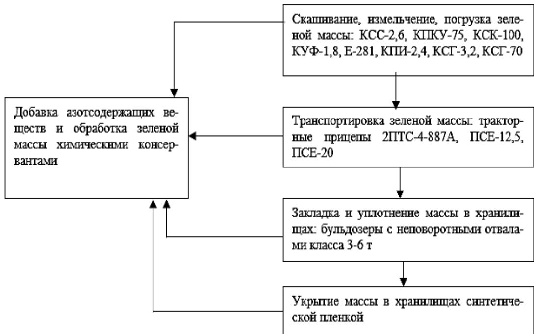
Рисунок 7.1 - Технологическая схема силосования зеленых кормов
