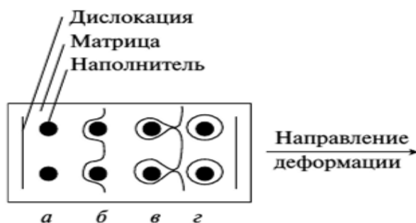
Рис.24. Схема торможения пластической деформации зернами наполнителя:
