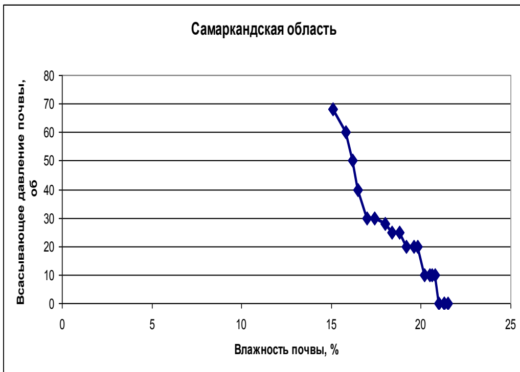
Рис. 3.12. Зависимость всасывающего давления от влажности почвы в период между первым и вторым поливом
