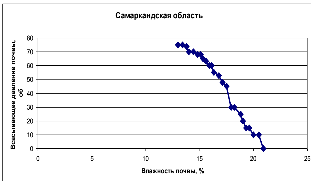
Рис. 3.14. Зависимость всасывающего давления от влажности почвы в период между третьим и четвертым поливом
