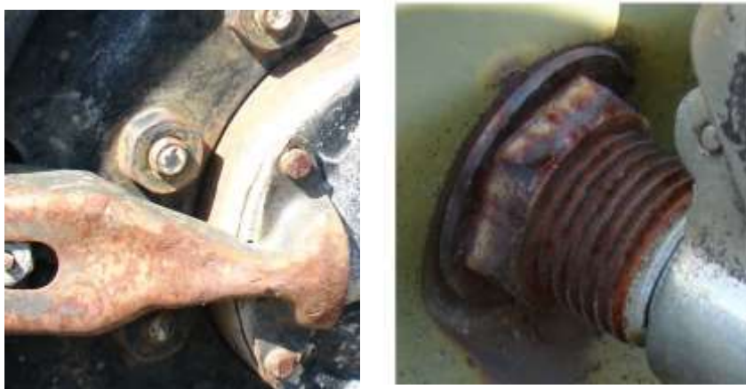
Рисунок 1 - Внешний вид резьбовых соединений сельскохозяйственной техники при эксплуатации и длительном хранении
