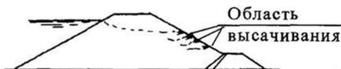
Рис. 4.32. Образование области высачивания на низовом откосе плотины (качественный диагностический показатель)
