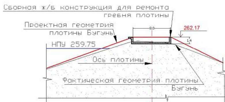
Рис. 4.14. Использование железобетонных лотков при наращивании гребня плотины Бугуль в Казахстане [46]
