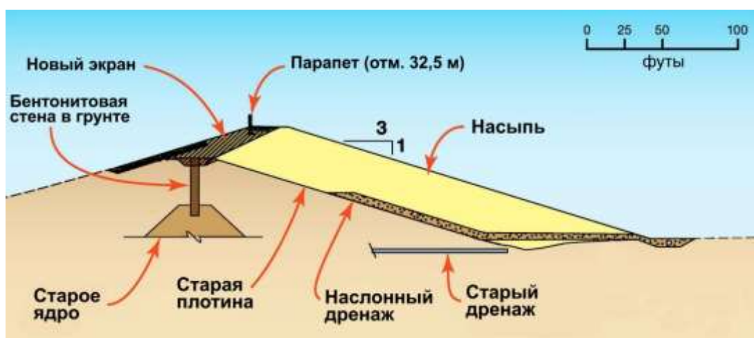
Рис. 3.6. Поперечный разрез по плотине
