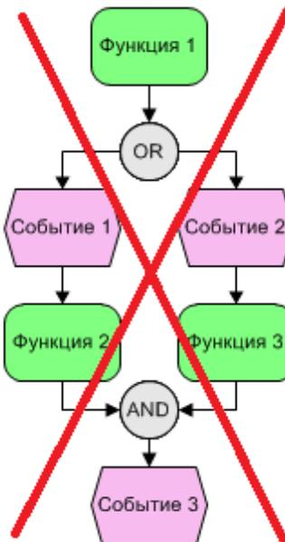
Рис. 2.71 Пример ошибки при использовании операторов
