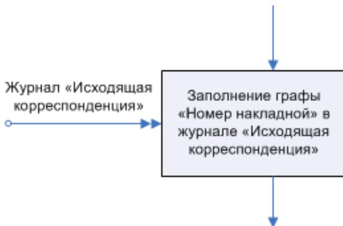
**Рис. 2.22 Стрелка "Поток объектов" с туннелированным началом**
