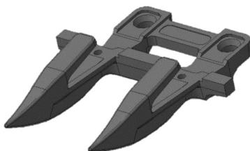
**Рисунок 1 – Модель пальца для жатки в 3D**
