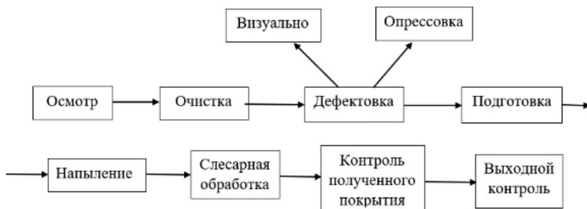
**Рисунок 2 – Технологический процесс восстановления герметичности интеркулера**
