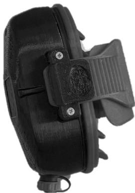
**Рисунок 1 – Внешний вид контрольного терминала для мониторинга начала родов у коров**
