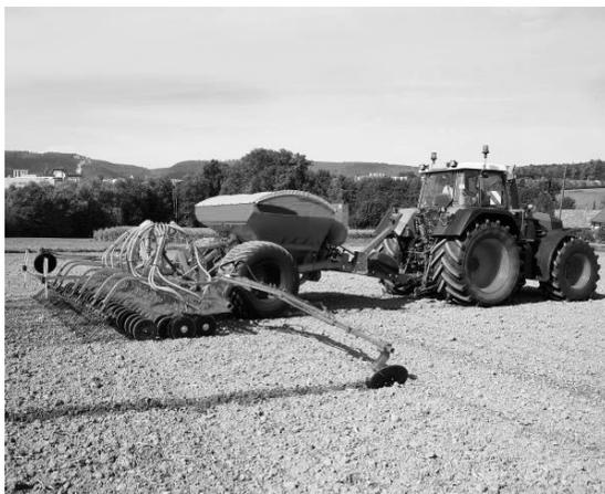
**Рисунок 3 – Трактор с посевным комплексом**
