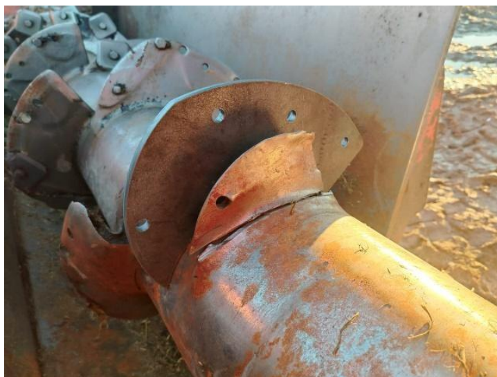
Рисунок 2 – Изношенный виток шнека в сравнении с новым
