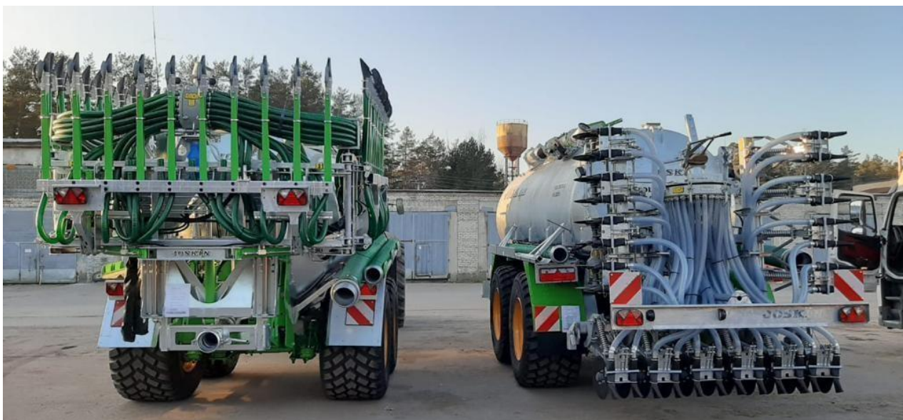
Рисунок 3 – Машины для внесения жидких органических удобрений с низкоэмиссионными рабочими органами (изготовлены по ТЗ ИАЭП) – филиала ВИМ)
