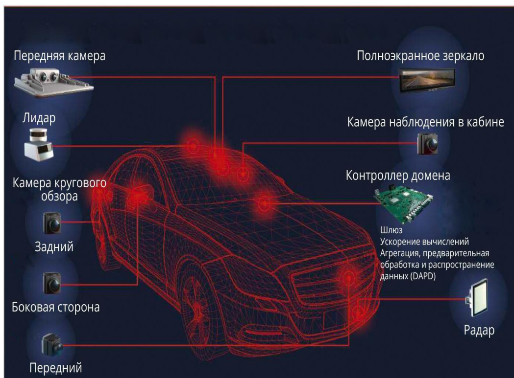
Рисунок 1 – Схема электромобиля с датчиками и процессорами
