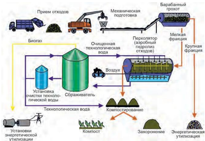
Рис. 9. Технологическая схема компостирования органических отходов с аэробными окислением и гидролизом отходов
