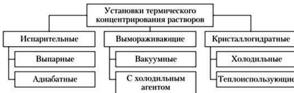
Рис. 59 Классификация установок термического концентрирования
