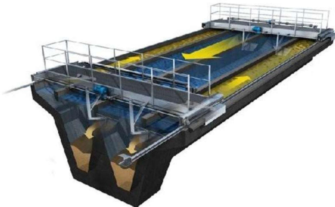
Рис. 19 Общий вид горизонтальной песколовки с передвижным
