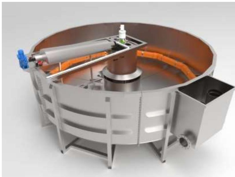
Рис. 45 Радиальный флотатор: 1 – подвод конденсата, насыщенного воздухом; 2 – отвод очищенного конденсата; 3 – отвод масляной пены с водой; 4 – отвод шлама; 5 – распределительное устройство; 6 – приводная станция – редуктор для гребков; 7 – гребки; 8 – приемная труба для масляной пены; 9 – подвод пара для разжижения и отделения масла от воды в приемной трубе
