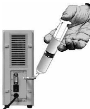
Рис.14. Промывка анализатора «Лактан 1-4 М»
