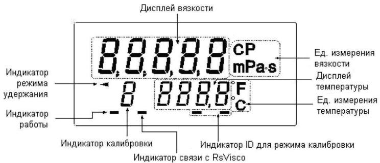
**Рис.15. Дисплей вискозиметра SV-100**
