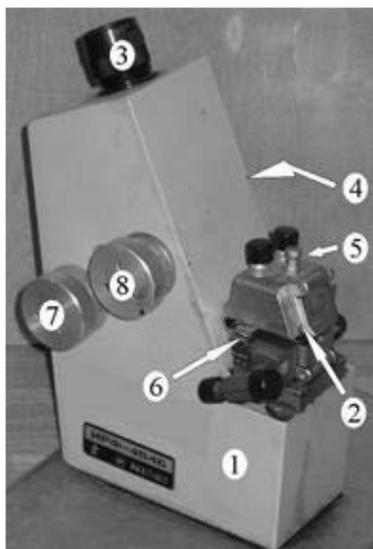
Рис.16. Внешний вид рефрактометра ИРФ-454 Б2М
