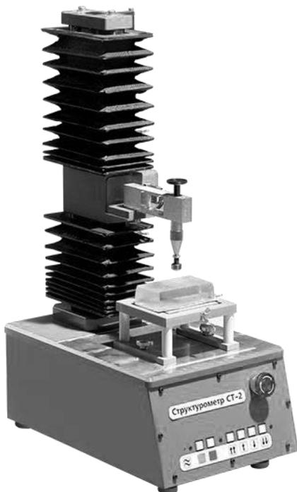
Рис. 21. Внешний вид структурометра СТ-2
