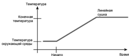
Рис. 9. Линейная программа сушки
