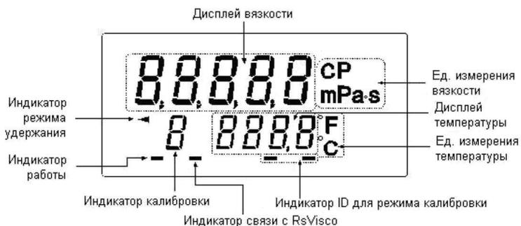
Рис. 15. Дисплей вискозиметра SV-100
