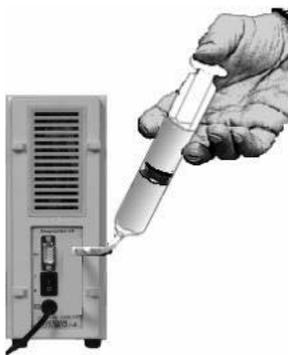
Рис.14. Промывка анализатора «Лактан 1-4 М»
