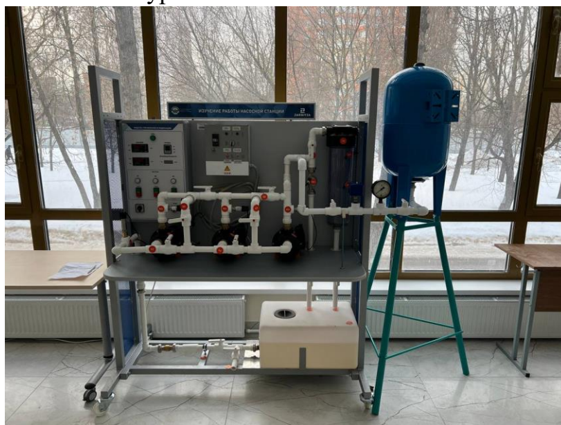
Рис. 2 Испытательный стенд системы водоснабжения с применением гидроаккумулятора
