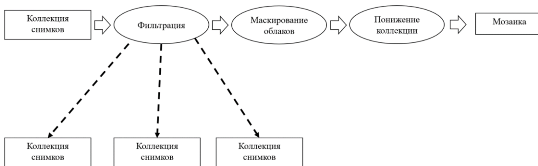
Рис 1 Схема фильтрации спутниковых снимков для формирования композита
