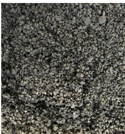
Рис. 1 Геомат заполненный щебнем и битум-полимерным вяжущим
