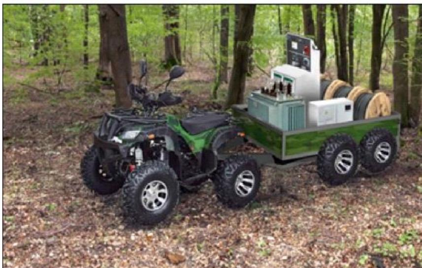
**Рис. 2 Мобильная модульная трансформаторная подстанция**
