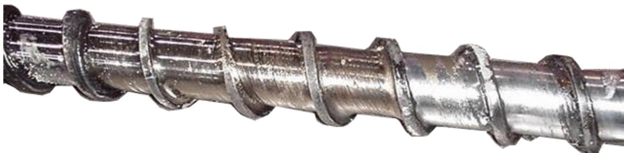
Рис. 1 Абразивный износ шнека
