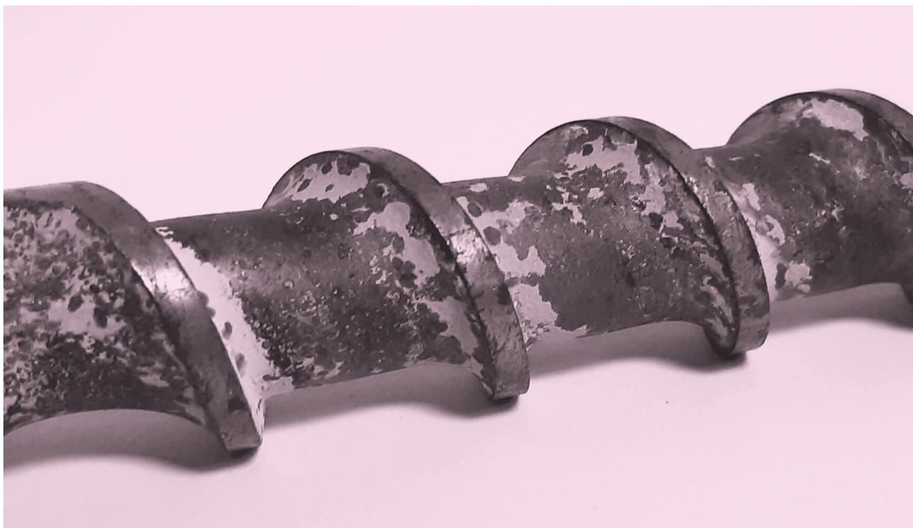
**Рис. 2 Коррозионный износ шнека**
