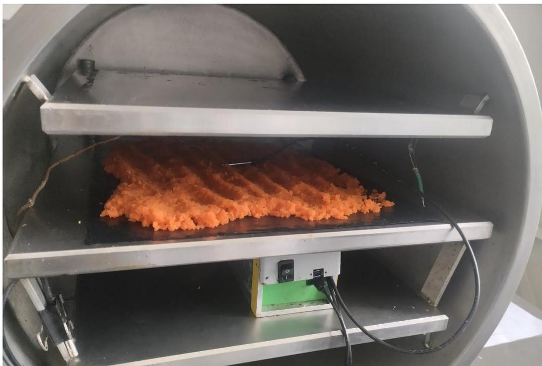
**Рис. 1 Сушка мезги моркови в вакуумной камере**
