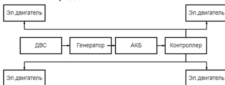
**Рис. 1** Общая схема комбинированной гибридной силовой установки №1
