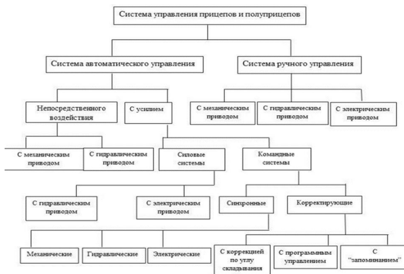
Рисунок 1 – Типовые модели систем управления поворотом автопоездов различного назначения.
