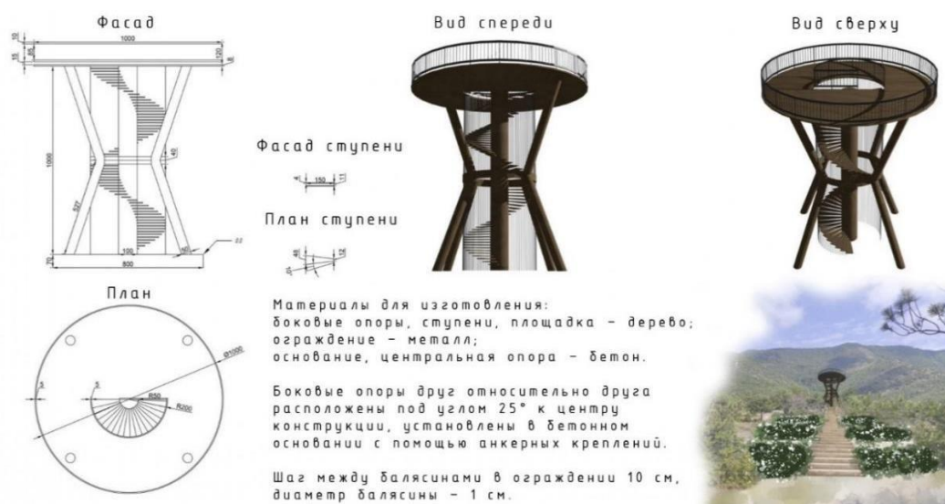
Рисунок 5 – Конструкция смотровой вышки «Силуэт невесты»
