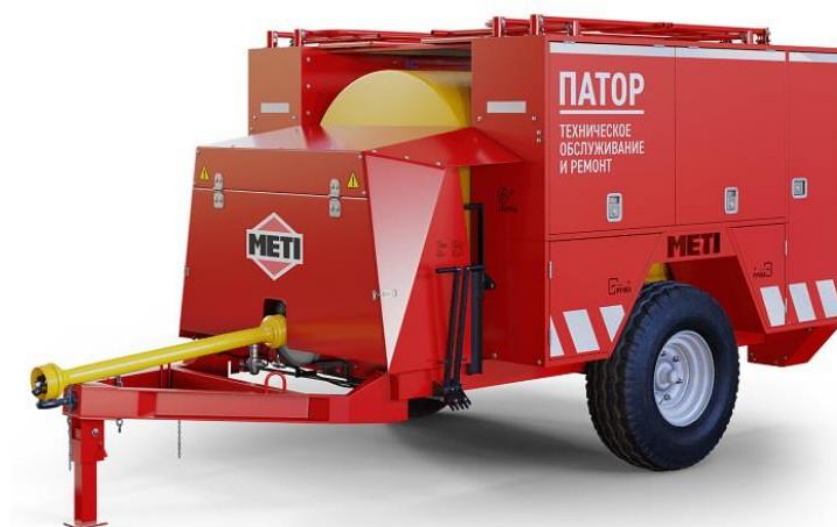
Рисунок 2 – Прицепной агрегат технического обслуживания и ремонта ПАТОР С
