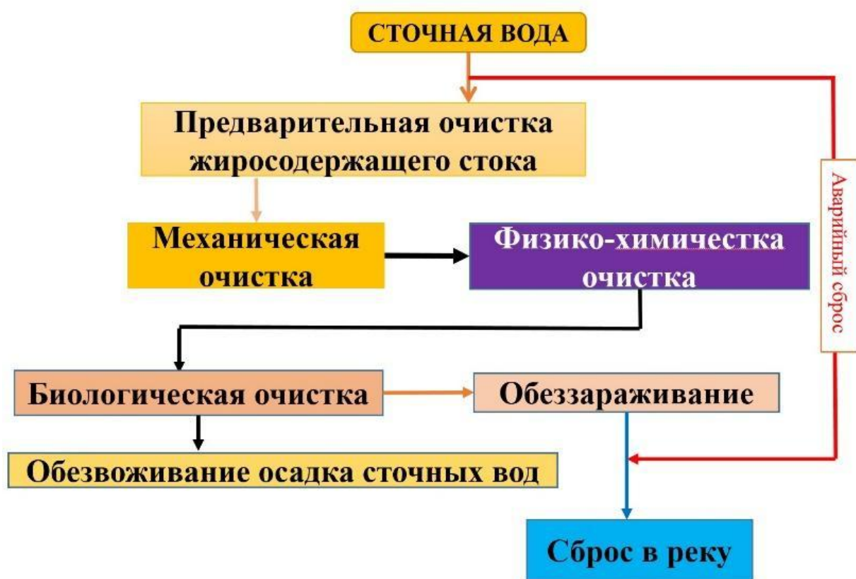
Рисунок 1 – Схема очистки сточных вод локальных очистных сооружений
