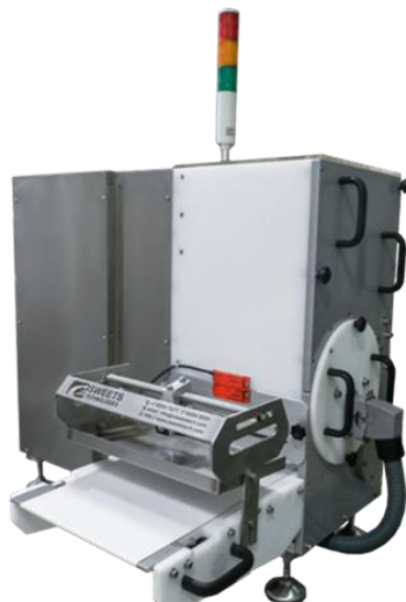
Рисунок 1 – Общий вид формующей машины ММС 200
