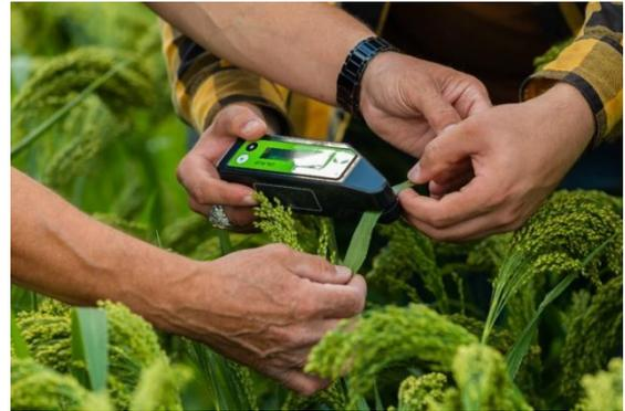
**Рисунок 2 – Измерение уровня хлорофилла в листьях просо с помощью прибора atLEAF CHL PLUS, Полевая опытная станция РГАУ-МСХА, 2024 г.**
