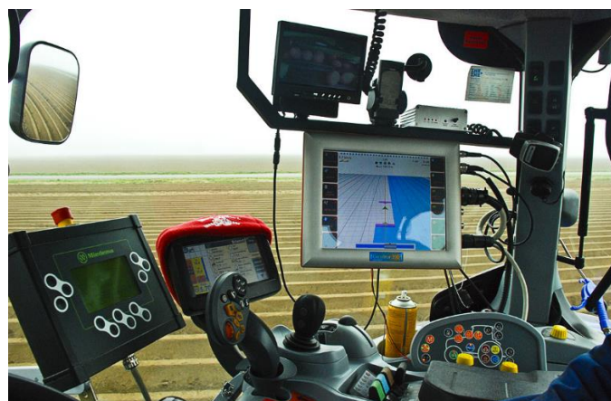
Рисунок 4 – Схема работы GPS системы в тракторе
