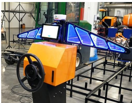
Рисунок 2 - Разрабатываемая ООО «Пегас-Агро» собственная система автоматизации параллельного вождения комплекса «Туман»
