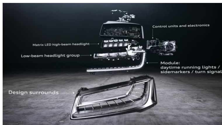
Рисунок 2 - Конструкция светодиодной оптики
