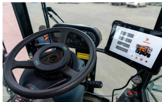
Рисунок 2 - Разрабатываемая ООО «Пегас-Агро» собственная система автоматизации параллельного вождения комплекса «Туман»
