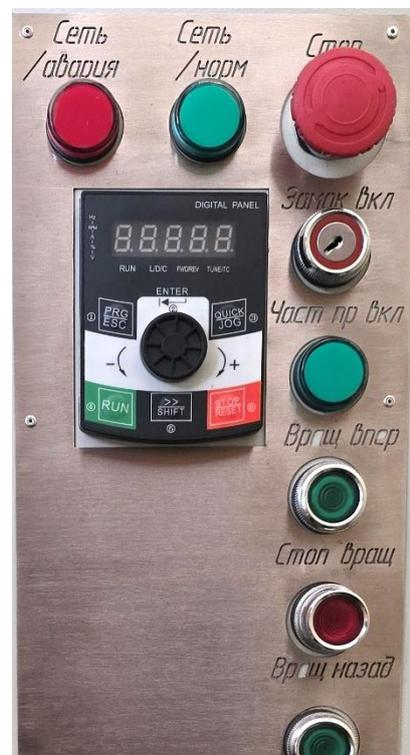
**Рис. 4. Модуль управления стеновой установкой**
