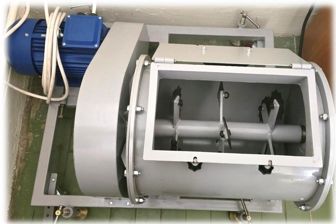
**Рис. 2. Установка для ускоренных испытаний на коррозионно-механический износ режущих элементов сельскохозяйственных машин для животноводства и кормопроизводства**
