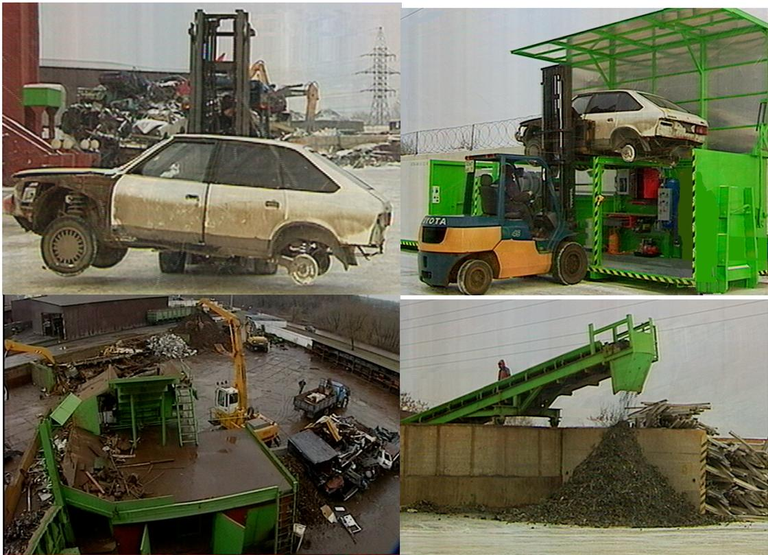
Рис. 1.15 – Технологическая цепочка утилизации автомобилей промышленной компании «Втормет»
